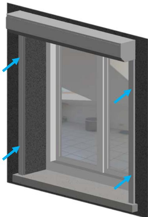
Positionnez le volet autour tableau et tracez les trous de perçage à travers les perçages des coulisses
