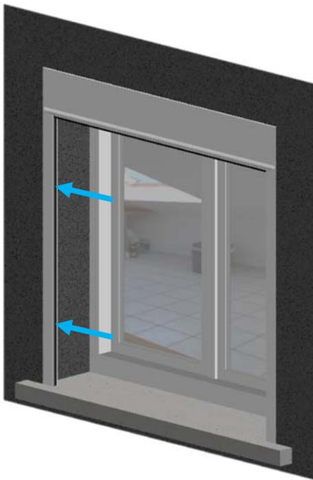
Positionnez le volet dans le tableau et tracez les trous de perçage à travers les perçages des coulisses
