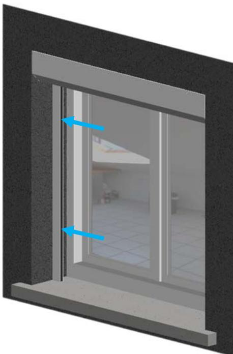
Positionnez le volet dans le tableau et tracez les trous de perçage à travers les perçages des coulisses
